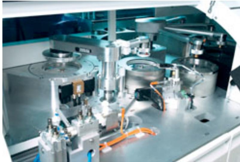
Successivamente subisce la metallizzazione (**sputtering**) attraverso l'evaporazione a caldo di un composto a base di alluminio che si deposita sullo strato di policarbonato stampato per pressione. Per evitare che tale strato metallico si possa ossidare o rovinare, viene ricoperto con una lacca, che crea anche una barriera alle impronte digitali che potrebbero alterare il contenuto del CD, oltre a creare una zona di focalizzazione ben precisa al di sotto del suo spessore.
